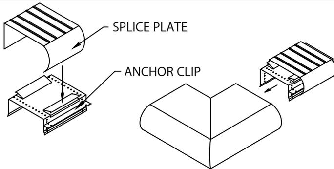
**STEP 2 - MITER SPLICE PLATES & ANCHOR CLIPS**
