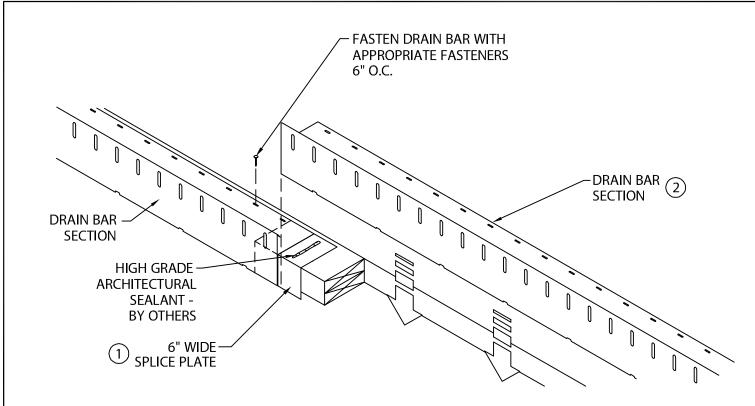
STEP 1 - LOCATE 6" WIDE SPLICE PLATES AT EACH JOINT.
