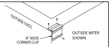
STEP 1 - CORNER SUPPORT CLIPS LOCATE AND FASTEN ONE 8" WIDE GALVANIZED CORNER SUPPORT CLIP TO ONE SIDE OF WALL.
