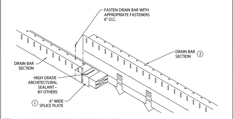
STEP 1 - LOCATE 6" WIDE SPLICE PLATES AT EACH JOINT.
