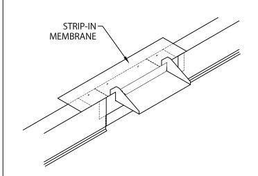
STEP 4 - STRIP-IN MEMBRANE STRIP-IN SCUPPER FLANGE.
