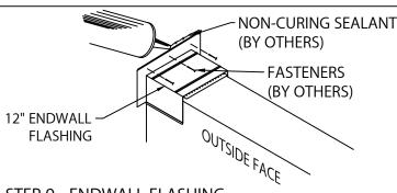
STEP 9 - ENDWALL FLASHING ENDWALL FLASHING SPLICE VERSION STEPS 9 -10
