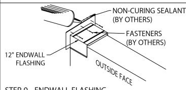
STEP 9 - ENDWALL FLASHING ENDWALL FLASHING SPLICE VERSION STEPS 9 -10
