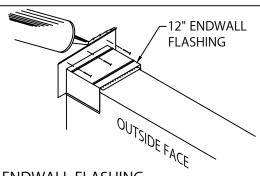
STEP 9 - ENDWALL FLASHING ENDWALL FLASHING SPLICE VERSION STEPS 9 -10
