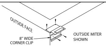
STEP 1 - CORNER SUPPORT CLIPS LOCATE AND FASTEN ONE 8" WIDE GALVANIZED CORNER SUPPORT CLIP TO ONE SIDE OF WALL.
