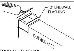
STEP 9 - ENDWALL FLASHING ENDWALL FLASHING SPLICE VERSION STEPS 9 -10
