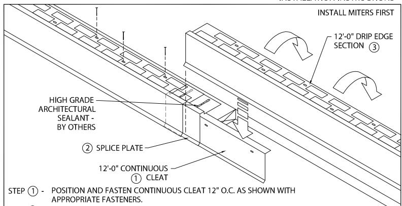
STEP ② - LOCATE AND FASTEN 6" WIDE SPLICE PLATES AT EACH JOINT.
